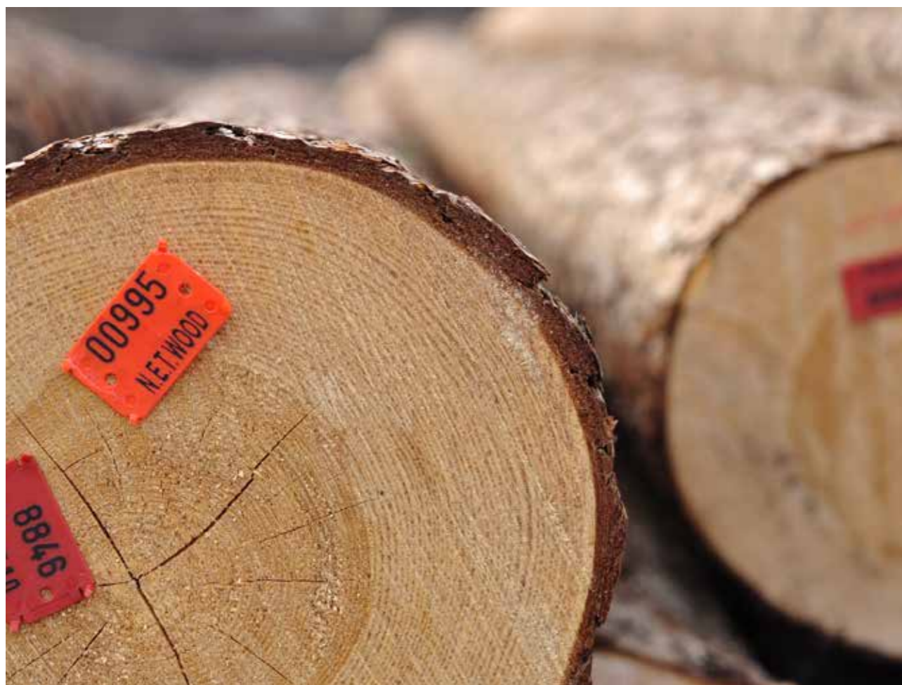
► Drewno na słupy musi być proste, mieć odpowiednią budowę i specyficzną średnicę. Fot. N.E.T. WOOD
