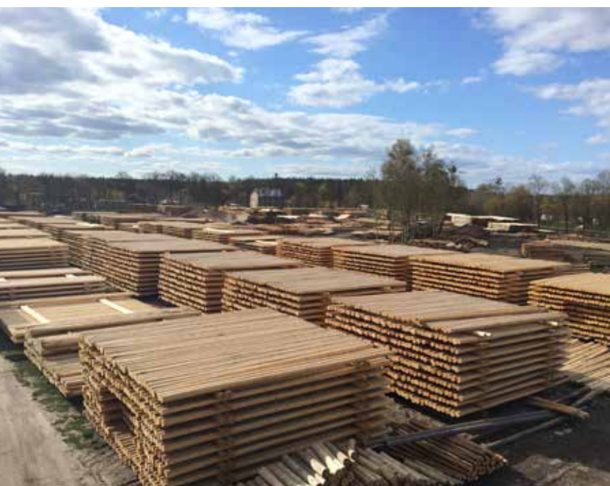
► Słupy przechodzą cały proces produkcyjny oprócz impregnacji ciśnieniowej i w takiej postaci są dostarczane do klientów. Fot. N.E.T. WOOD
